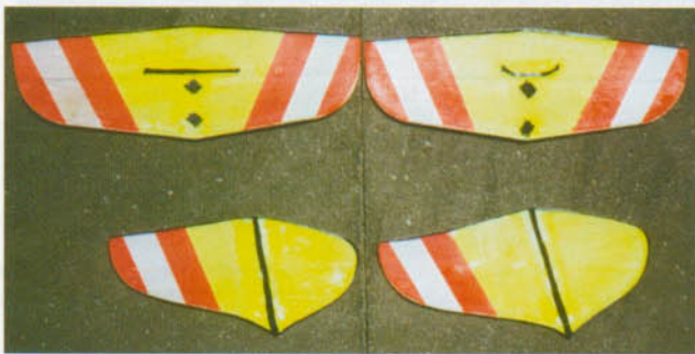
▲ Diese Leitwerke wurden für einen SAL- Segler gebaut
